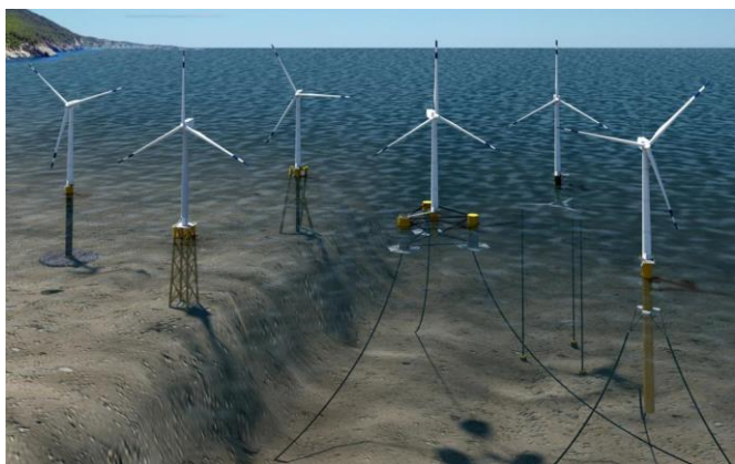
Différentes technologies de fondations posées et flottantes existantes © Carbon Trust
