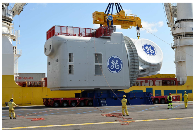
Nacelle de l'Haliade X, de 12 MW, construite par General Electric à Montoir de Bretagne.
