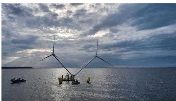
Figure 1: Le prototype 1:10 Nezy<sup>2</sup> installé par EnBW sur un lac puis en mer Baltique, source : EnBW
