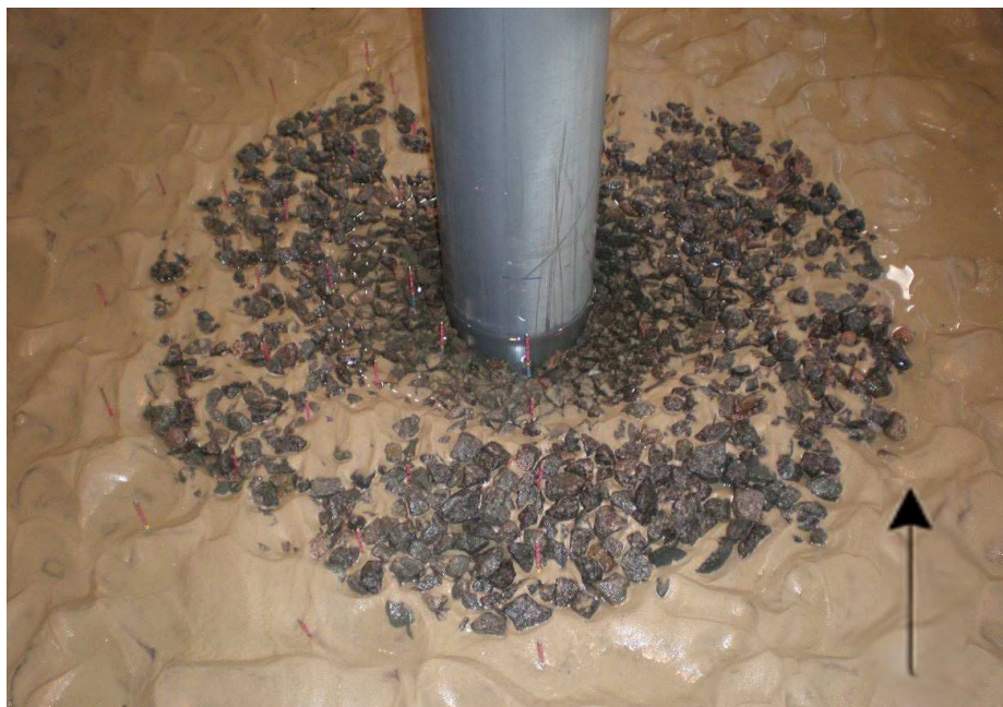
Figure 8 : Mouvements sédimentaires autour d'une structure fixée sur le fond marin.
